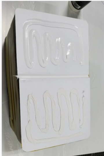
Scellant au moment de l'application
