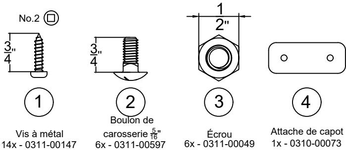
Vis à métal 14x - 0311-00147      Boulon de carrosserie  $\frac{5}{16}$ " 6x - 0311-00597      Écrou 6x - 0311-00049      Attache de capot 1x - 0310-00073
