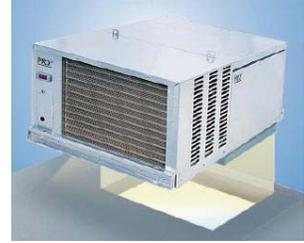
3.1.2 L'unité de réfrigération conventionnelle refroidie à l'air : Celle-ci est facilement reconnaissable au radiateur du condenseur. Ce type d'unité est le plus répandu, il **nécessite une bonne ventilation** là où il est installé pour assurer son fonctionnement normal. Ce système doit être connecté à un évaporateur (situé dans la chambre froide).
